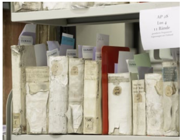
Hitze- und löschwassergeschädigte Pergamenteinbände vor der Restaurierung
